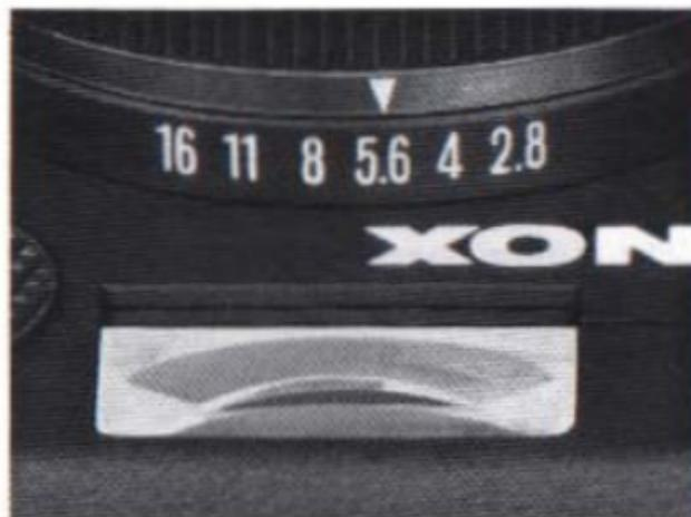
Eine hohe Blendenzahl (z. B. 11 oder 16) bezeichnet eine kleine Blendenöffnung, eine niedrige Blendenzahl z. B. 2,8 oder 4) eine große Blendenöffnung. Je höher die Blendenzahl, desto größer ist die Schärfentiefe (der Entfernungsbereich, in dem die Aufnahmen eine ausreichende Schärfe aufweisen), desto länger ist aber die Belichtungszeit.
