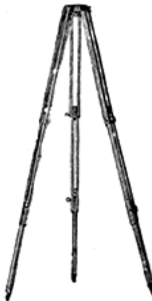
Bild 101. Stativ mit festem Kopf.
