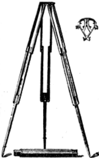
Bild 100. Stativ mit abnehmbarem Stativdreieck.
